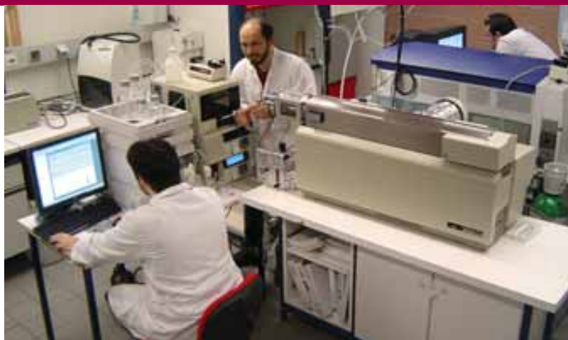
Couplage de la chromatographie liquide et de l'appareil de spectrométrie de masse.
