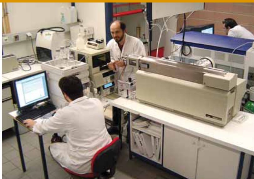
Couplage de la Chromatographie Liquide (CL) et de l'appareil de Spectrométrie de Masse (SM) en tandem.
