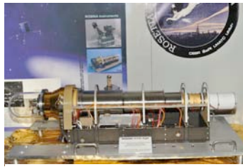
Un des spectromètres de ROSINA
