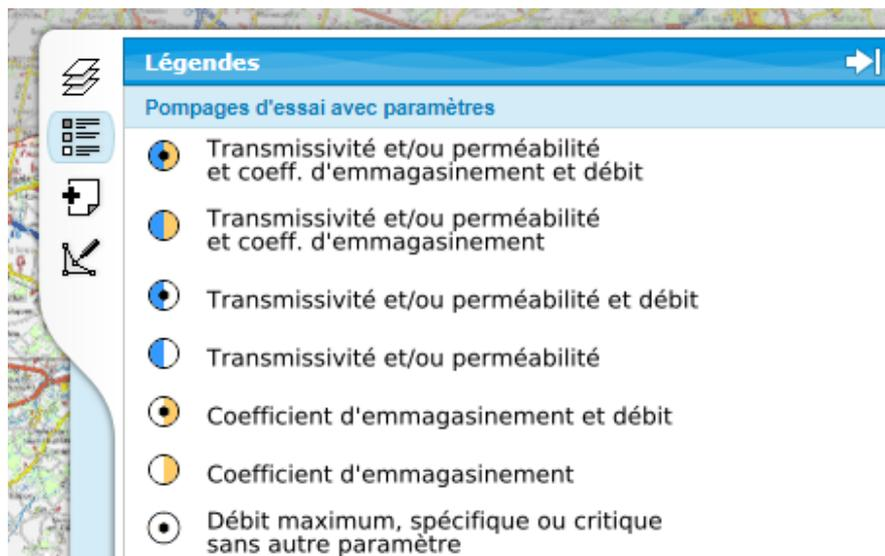
Illustration 22 : Légende des ouvrages avec pompages d'essai.
