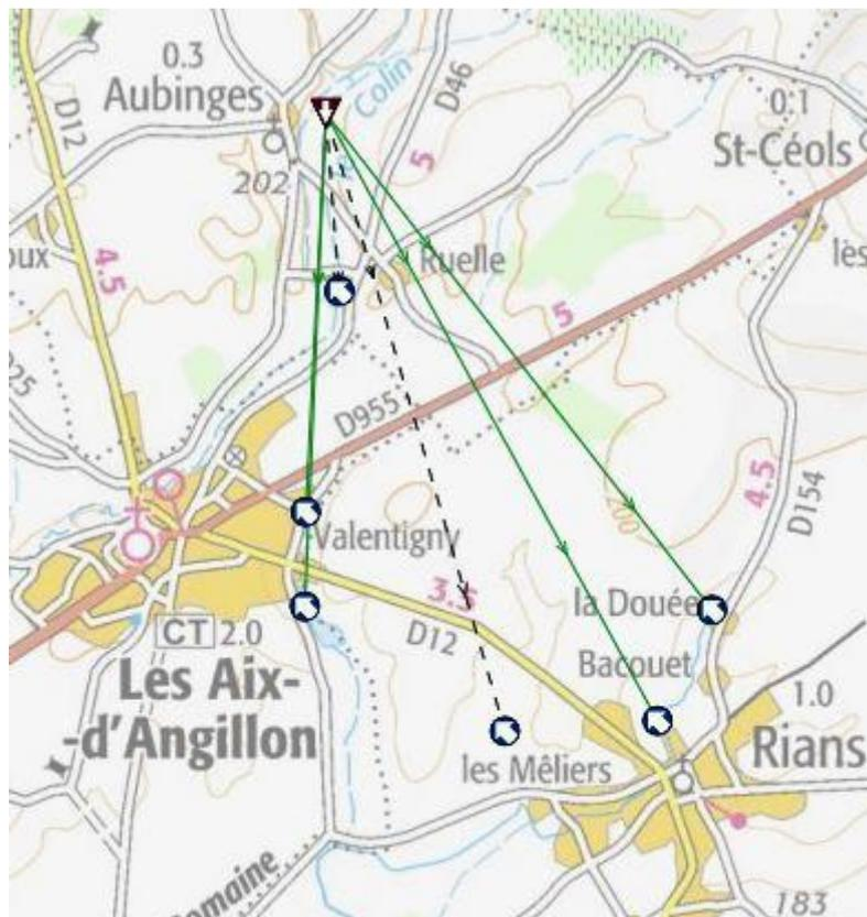
▽ Point d'injection    ● Point de surveillance    — Traçage positif    - - - Traçage négatif
