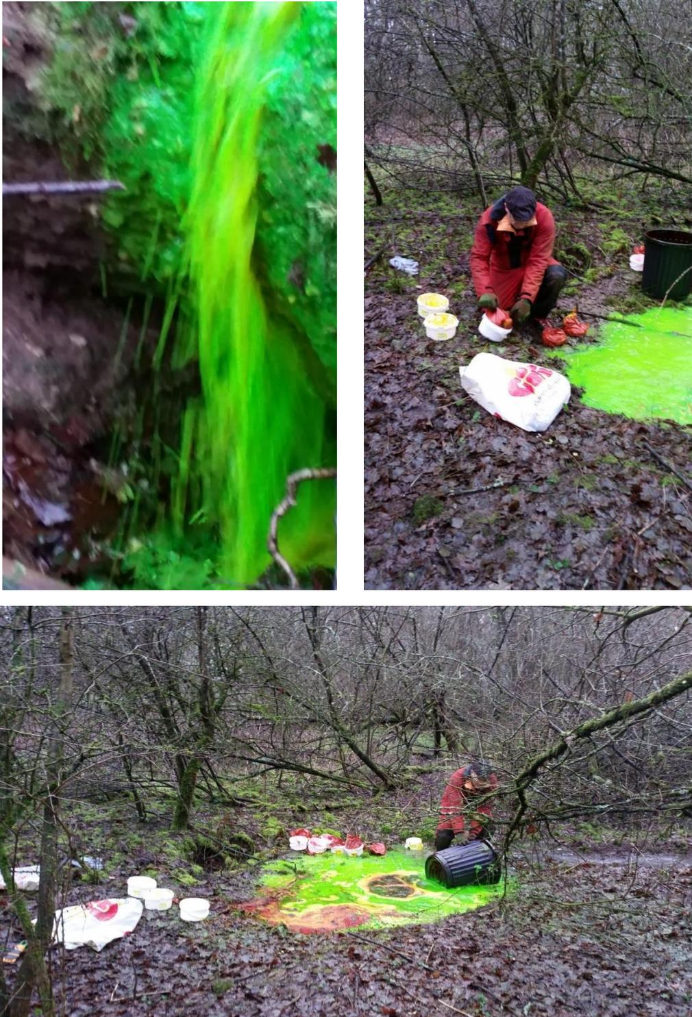
*Figure 3 : Injection du traceur le 16 janvier 2023 : trois dolines contiguës ont absorbé le traceur ; la plus large qui a permis la dissolution de la fluorescéine, la deuxième en bordure aval (visible sur la photo du bas), et la troisième, la plus creuse, décalée en rive gauche dans laquelle le traceur cascade (avant remplissage de la doline, photo en haut à gauche).*
