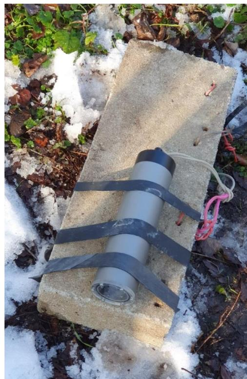
*Figure 7 : Mise en place du fluorimètre STREAM à la source de l'Archer aval le 18 Janvier après-midi*
