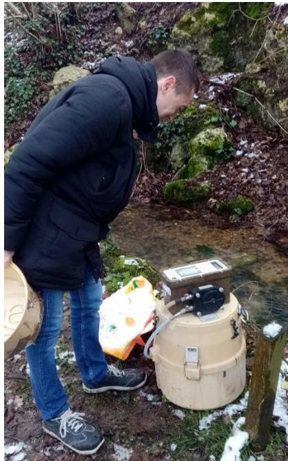
*Figure 6 : Préleveur automatique sur la source de l'Archer amont (limnimètre)*
