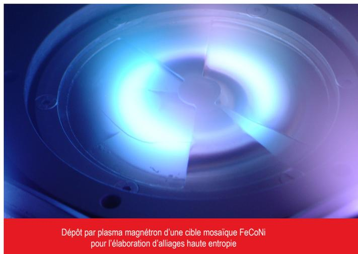
Dépôt par plasma magnétron d'une cible mosaïque FeCoNi pour l'élaboration d'alliages haute entropie
