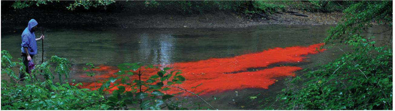
Photo 1. Injection de traceur fluorescent (sulforhodamine B) dans un cours d'eau superficiel du Val d'Orléans (cliché Timothée Dupaigne, MICA Environnement<sup>7</sup>, Lyon).
