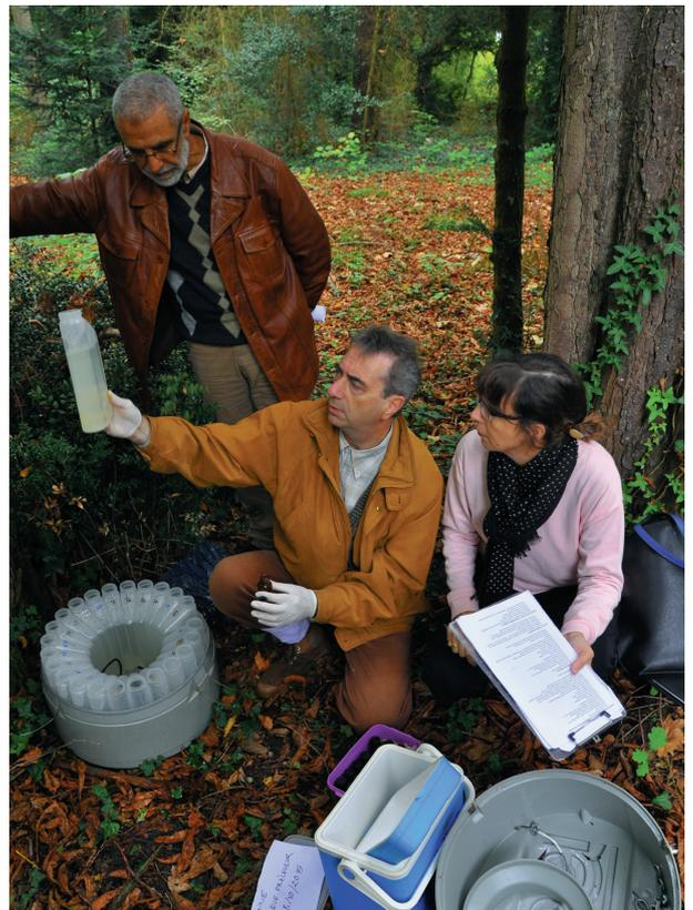
Photo 2. Récupération au bout de 3 jours des échantillons d'eau prélevés par préleveur automatique ISCO 3700 (cliché Timothée Dupaigne, MICA Environnement, Lyon).
