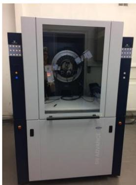
Un diffractomètre de rayons X qui permet l'analyse de la structure et de la microstructure de matériaux variés (poudres, films minces, matériaux mono et poly cristallins...). Cet équipement propose la technique de réflectométrie pour la mesure de l'épaisseur et de la densité de films minces.
