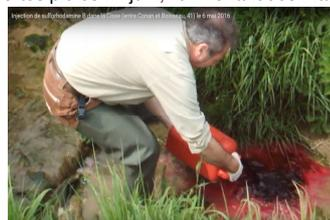
Fig. 7 : Injection de la sulforhodamine B
