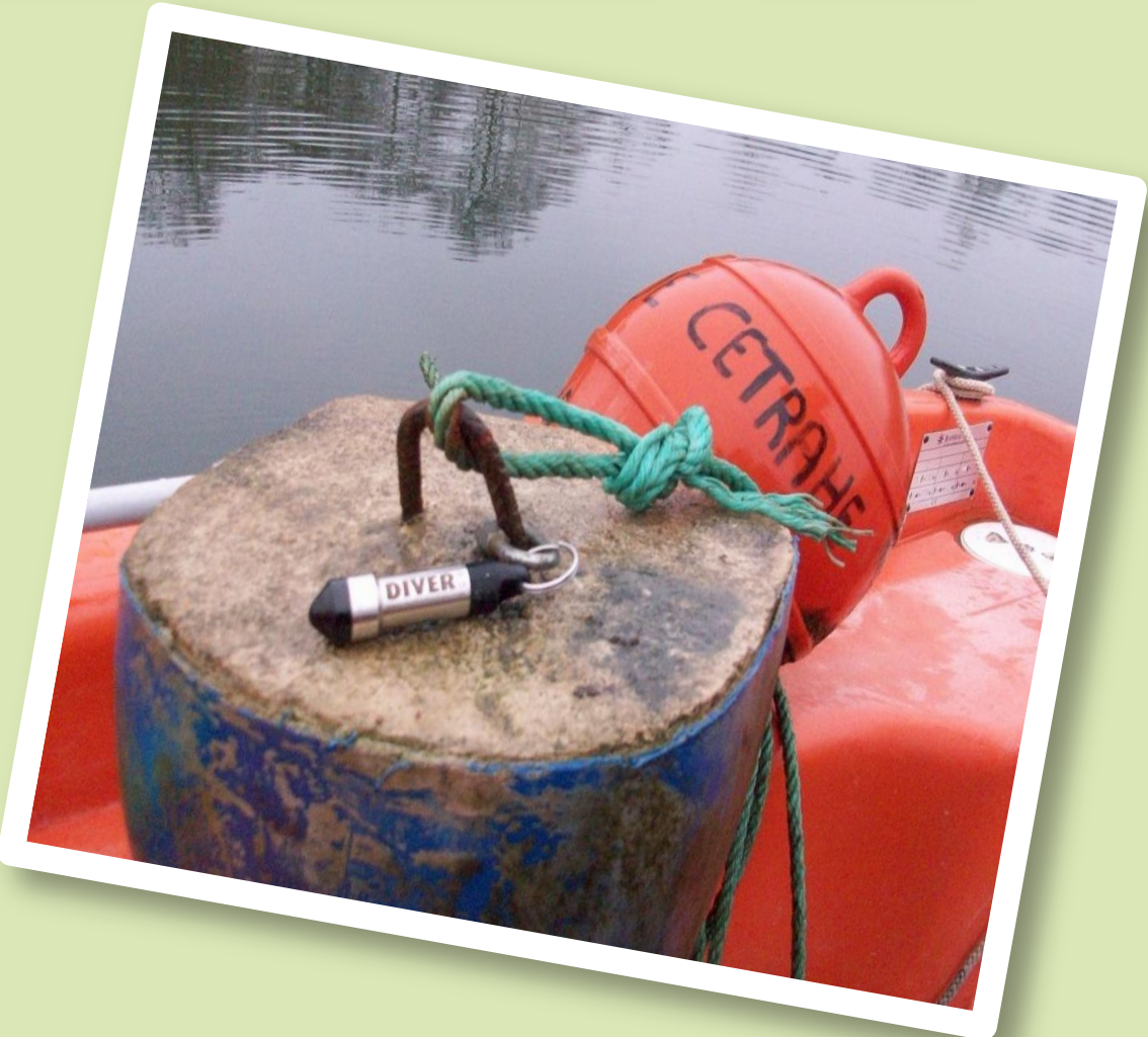
Sonde piézométrique immergée : mesures des variations de hauteur du plan d'eau
