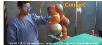
Robot Industriel kuka Iwa manipulé (Laboratoire Prisme-Near Lab)
