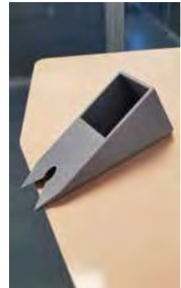
Prototype de support caméra fait en impression 3D
