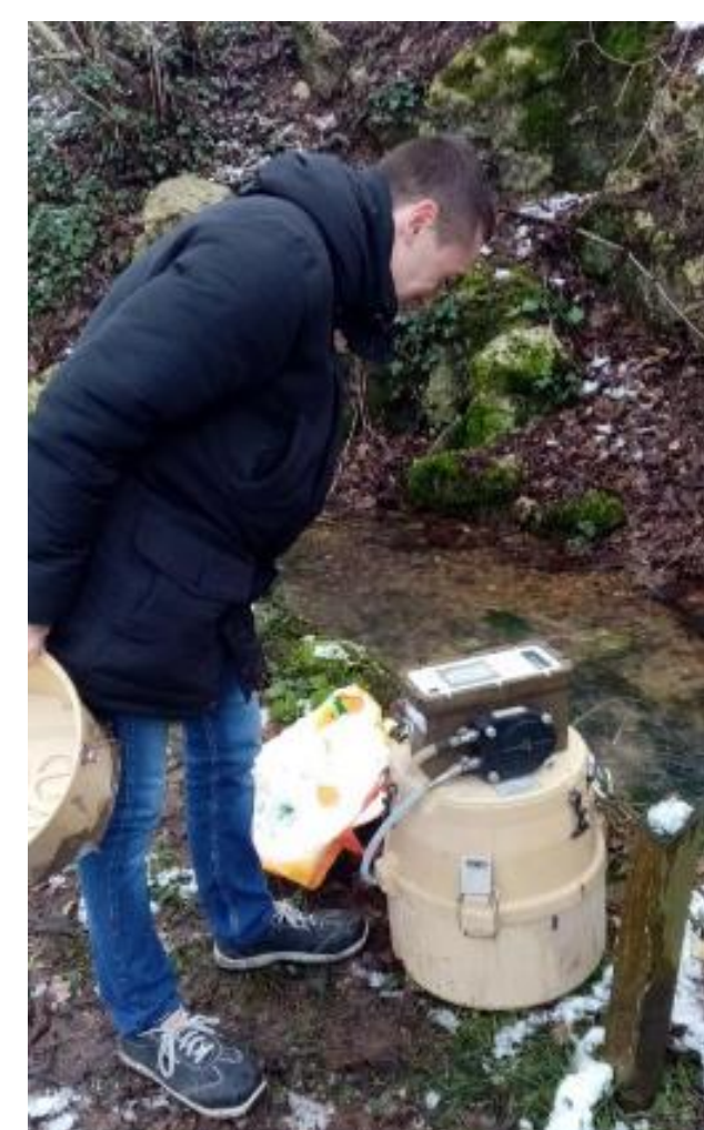
Fig. 4 : Installation du fluorimètre STREAM à l'une des sources de l'Archer.
