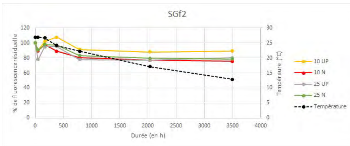
Figure 16 : Evolution avec le temps des intensités de fluorescence des solutions de sulforhodamine G de concentration 10 et 25 µg/L fabriquées à partir d'eau naturelle (N) et d'eau ultrapure (U). En haut intensités à t 0 ; au-dessous évolution jusqu'à 4 mois par produit.
