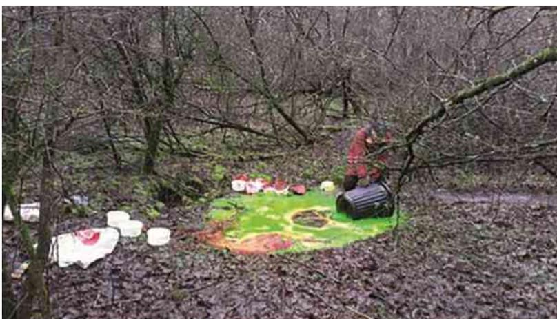
**Figure 2 :** Injection du traceur le 16 janvier 2023 : trois dolines contiguës ont absorbé le traceur ; la plus large qui a permis la dissolution de la fluorescéine, la deuxième en bordure aval (visible sur la photo du bas), et la troisième, la plus creuse, décalée en rive gauche dans laquelle le traceur cascade (avant remplissage de la doline, photo en haut à gauche).
