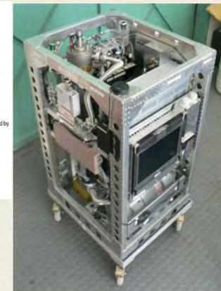
**- Gaz a effet de Serre** N<sub>2</sub>O, CH<sub>4</sub> et CO<sub>2</sub> -> SPIRIT : Spectromètre à lasers infrarouges (QCL) du LPC2E (<http://www.lpc2e.cnrs.fr/spip.php?article152>)
