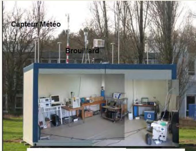
Super site Voltaire: analyseurs chimiques (à gauche) et station météo (à droite), localisé au CNRS entre ICARE et le LPC2E
