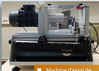
■ Machine d'essai de fatigue des matériaux
