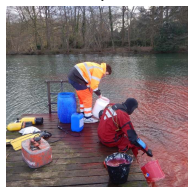
Fig. 3 : Injection de la sulforhodamine B dans la perte de Viveret.
