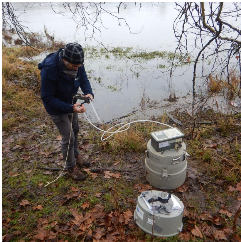
Figure 6 : Installation du préleveur automatique aux sources de Bellevue amont (source « Lepiller »)
