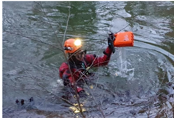
Figure 3 : Début de plongée dans la source de l'Abîme pour l'injection de l'uranine dans la galerie aval située à 100 m de l'entrée. Le traceur est contenu dans le jerrycan orange de 5 litres.
