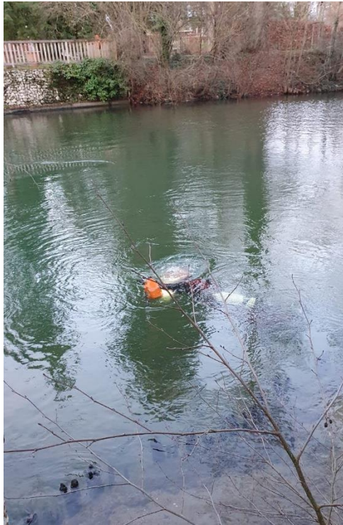
Figure 3 : Début de plongée dans la source de l'Abîme pour l'injection de l'uranine dans la galerie aval située à 100 m de l'entrée. Le traceur est contenu dans le jerrycan orange de 5 litres.
