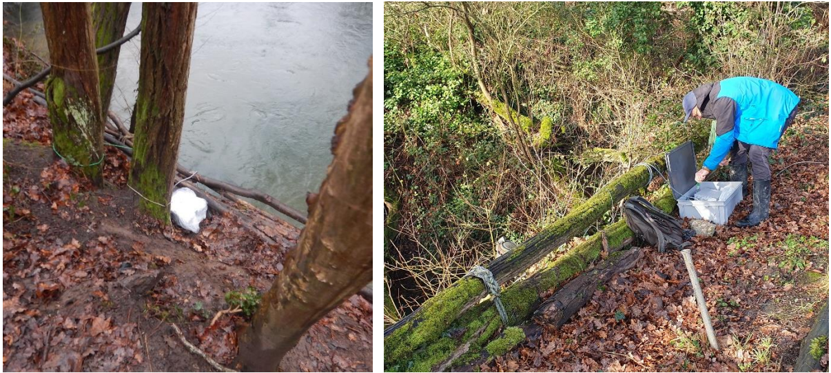
Figure 5 : Mise en place du fluorimètre FL30 à la source des Béchets (gauche) et du fluorimètre FL24 au gouffre de Montauban (droite)
