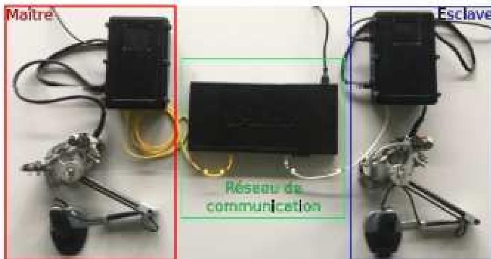
Figure 6.3: Système haptique maître-esclave.
